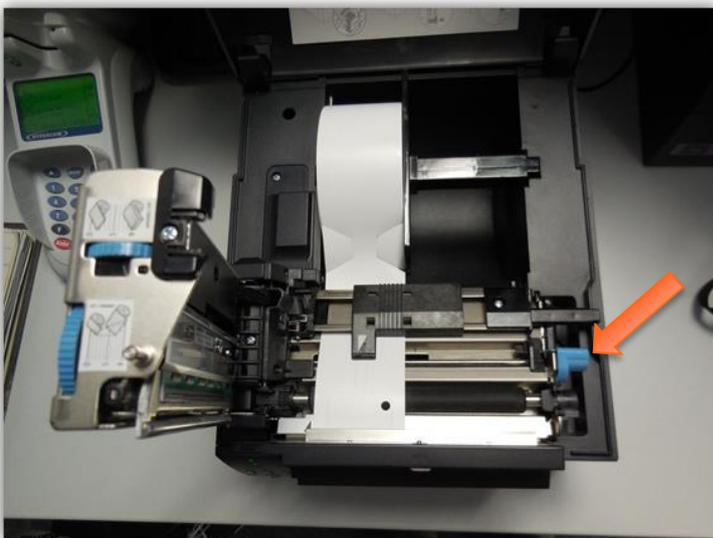
Klappen Sie zunächst den Thermodruckkopf nach oben. Zum Entriegeln benutzen Sie den an der rechten Seite befindlichen Entriegelungshebel.
