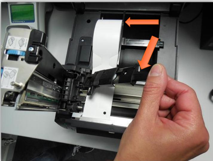
Klappen Sie auch diesen Hebel an dem seitlichen Verschluss nach oben, um an die Papierlage zu gelangen. Nun kann die Rolle getauscht werden. Achten Sie darauf, dass die Rolle so eingesetzt werden muss, dass die bedruckbare, weiße Seite oben ist. Nach dem „Neueinlegen“ des Papiers bitte auch die Begrenzungsschiene wieder bündig aufschieben, damit sich das Papier nicht verziehen kann oder schräg eingezogen wird.
