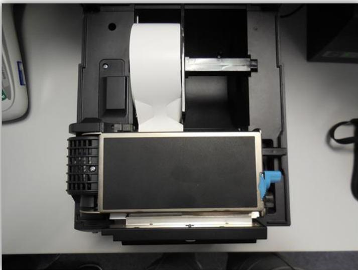
Die Abbildung zeigt den Drucker, die Schutzklappe wurde bereits nach hinten aufgeklappt.
