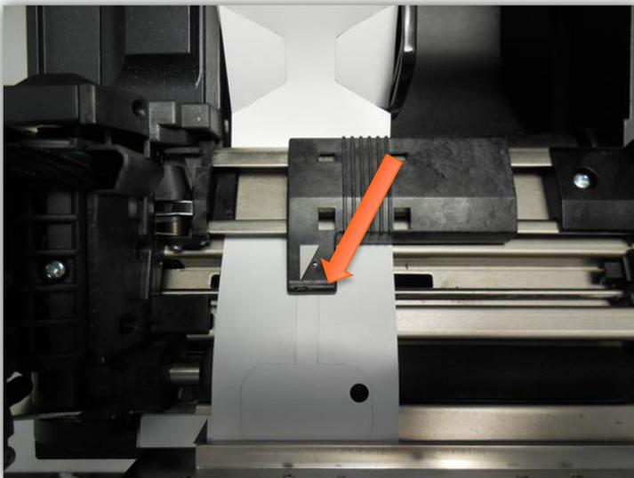
Die Papierlage ist linksbündig, der darüber befindliche Sensorspiegel muss mittig zum Papier justiert sein, damit er die Stanzung am Ende eines jeden Greenfeedtickets erkennen kann und dann entsprechend das Ticket zurückzieht und schneidet.
